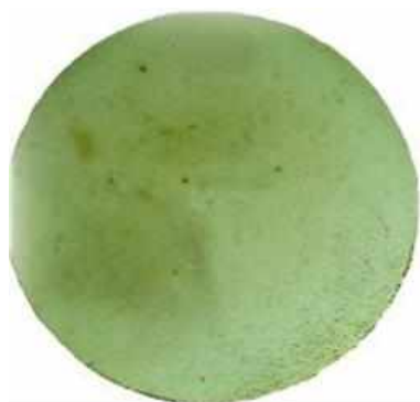
Рисунок 1. Фотография крупногабаритного образца (Ø 50 мм x 3 мм) – «мишени» состава \text{Ba}_{0.5}\text{Sr}_{0.5}\text{Nb}_2\text{O}_6
