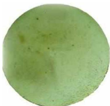
**Рисунок 1. Фотография крупногабаритного образца (Ø 50 мм х 3 мм) – «мишени» состава  $Ba_{0.5}Sr_{0.5}Nb_2O_6$**
